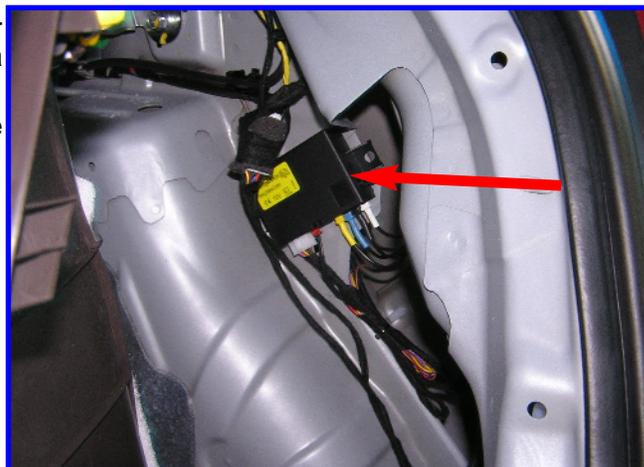
**SEGNALATORE ACUSTICO** : Fissare il segnalatore acustico (buzzer) sopra il supporto cintura di sicurezza sul fianco baule lato passeggero.
