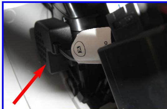
**PULSANTE LED:** Fissare il pulsante led sul cruscotto, in un luogo ben visibile dalla posizione di guida, facendo attenzione a rendere comodo e intuitivo l'azionamento da parte del guidatore e a non danneggiare il cavo durante le fasi di installazione.
