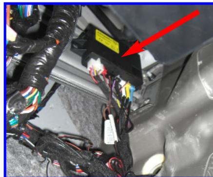
**SEGNALATORE ACUSTICO:** Posizionare il buzzer dietro la bocchetta dell'aria, lato guida.
