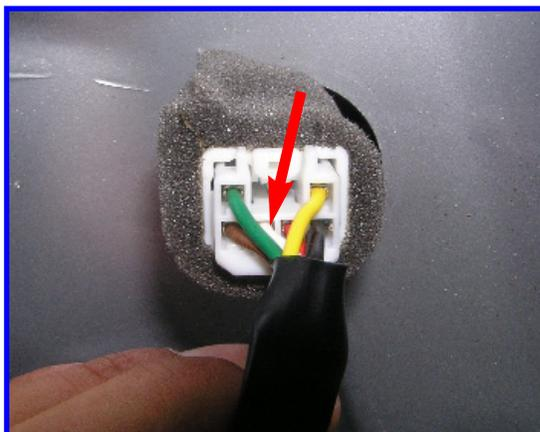
**NEGATIVO:** Per il collegamento elettrico individuare il filo NERO nel connettore da 6 poli del faro lato guida.
